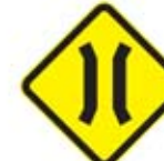
A-22 Ponte Estreita
