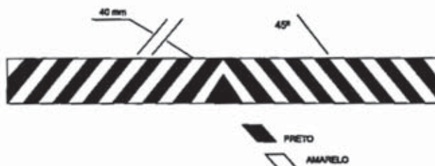
Figura 1 - Mostra como a travessa do pára-choque traseiro de veículo de carga (PBT maior que 3,5 toneladas) deve estar pintada, observando-se o espaçamento de 40mm entre as faixas e a inclinação de 45° das mesmas, bem como as cores determinadas.
