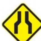
A-21a Estreitamento de pista ao centro
