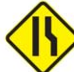
A-21c Estreitamento de pista à direita
