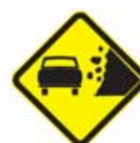
A-27 Área com desmoronamento
